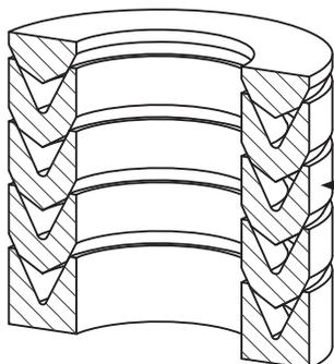
FOR VACUUM PACKING APPLICATIONS, REVERSE THE DIRECTION OF THE CUP OF THE PTFE PACKING RINGS (KEY 21) AS SHOWN.
