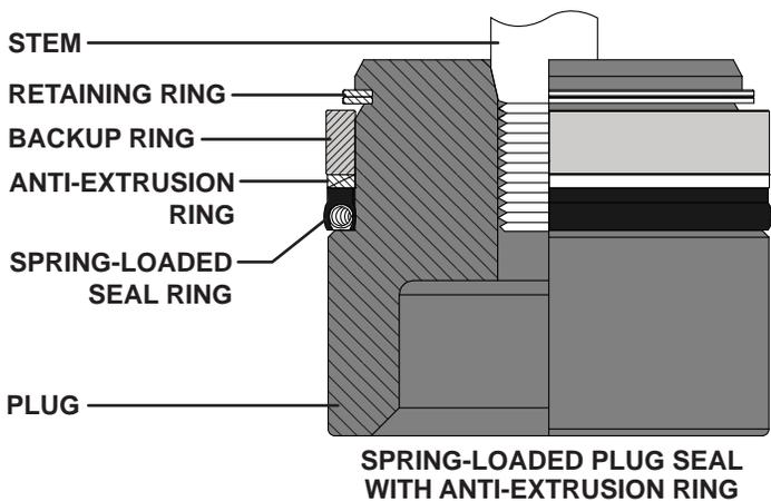
**SPRING-LOADED PLUG SEAL WITH ANTI-EXTRUSION RING**
